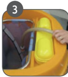
3 Remplir le réservoir de solution flexible (sac) avec de l'eau propre.
