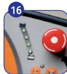
16 Les témoins verts indiquent le niveau de batterie. Si une DEL rouge s'allume, il vous reste 10 minutes pour amener la machine jusqu'à un endroit où recharger la batterie.
