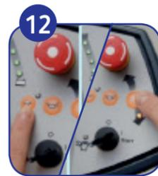
12 Appuyer sur le bouton de vitesse faible pour diminuer la vitesse maximale de déplacement. Appuyer sur le bouton de marche arrière pour transformer la marche avant en marche arrière, ou vice-versa.
