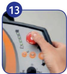
13 En cas d'urgence et de besoin d'arrêt et de coupure immédiats de la machine. Réinitialiser mécaniquement le bouton d'urgence en le tournant dans le sens horaire.
