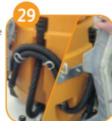
29 Placer les deux tuyaux d'aspiration et la raclette dans leurs supports pour entreposer la machine.
