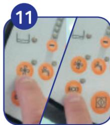
11 Activer le moteur à vide (aspiration) et le mode ÉCO pour diminuer le niveau de bruit en limitant la puissance d'aspiration.
