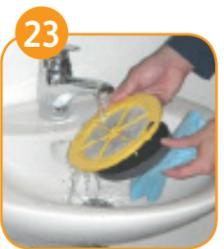
23 Nettoyer le filtre à poussière et l'unité flottante à l'eau courante, et laisser sécher à l'air.
