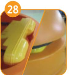
28 Retourner le filtre à poussière et entreposer la machine en gardant le couvercle entrouvert (le couvercle doit reposer sur le filtre à poussière) pour assurer son aération.
