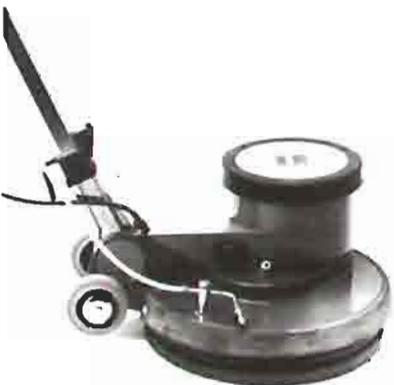
14. Arbeiten: schmutzige Stellen durch kurzen, kräftigen Kontakt am Betätigungshebel (C) mit Sprayemulsion besprühen und verarbeiten.
