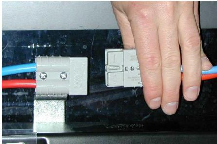
Eine Zwischenladung während des Arbeitens wird nicht empfohlen. Nach dem Laden Ladegerät ausschalten. Ladestecker trennen und internen Ladestecker wieder an Maschine einstecken.
