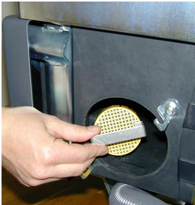
Bei täglichem Gebrauch Laugenfilter einmal wöchentlich auf Verschmutzung kontrollieren, gegebenenfalls reinigen.
