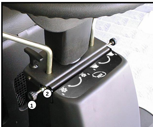
FIG. 8 - REGULACIÓN DEL CEPILLO CENTRAL
